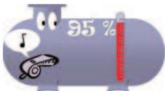
L'avertisseur est placé sur le conduit de ventilation du réservoir. Lors du remplissage, tant que le réservoir n'a pas atteint 95 % de sa capacité maximale, l'avertisseur émet un sifflement audible jusqu'au camion ravitailleur.
